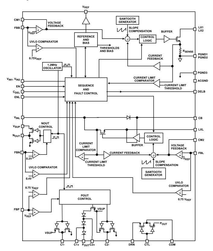
FIGURE 11. BLOCK DIAGRAM
