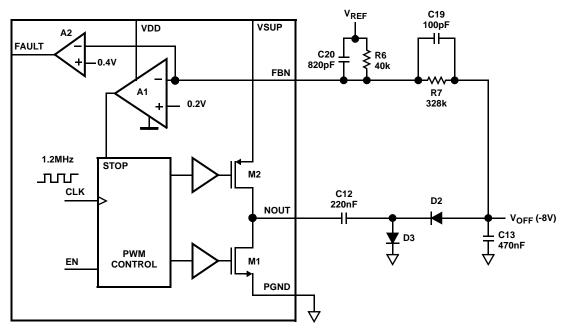
FIGURE 14. NEGATIVE CHARGE PUMP BLOCK DIAGRAM
